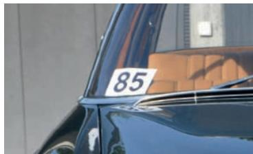
Der Kleber wird an der Frontscheibe in Fahrtrichtung gesehen unten rechts befestigt.
